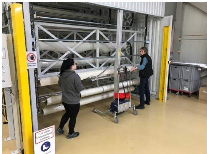
Abbildung 2: Bedienen des Paternosters
