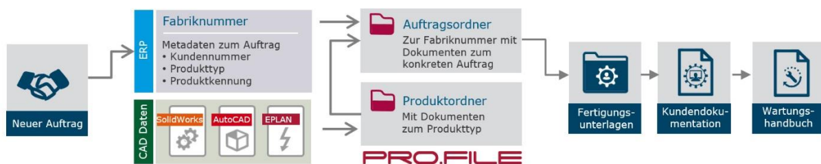
Abbildung-4: Digitale Dokumentenlenkung in der Abwicklung von Aufträgen bei einem Einzelfertiger am Beispiel PRO.FILE
