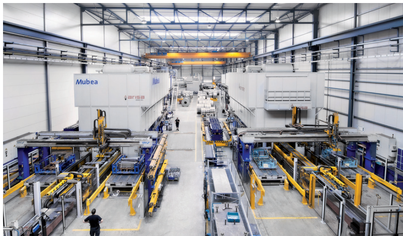
Fertigungsstrasse für flexibel gewalzte Produkte (Tailor Rolled Products)
